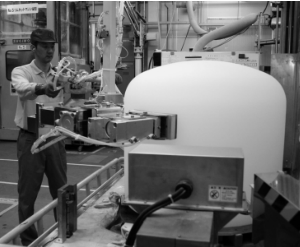
半導体の元になるシリコン単結晶を製造するときに使われる容器「石英ルツボ」を生産するジャパンスーパークォーツ株式会社(茨島)。高温・長時間の処理にも耐えられる、高純度の大型石英ルツボを製造し、世界で約6割のシェアを誇っています。
