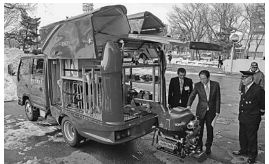
消火用ポンプや救助器具なども搭載しています。
