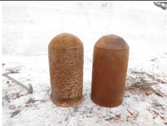
ポリピック摩耗状況
