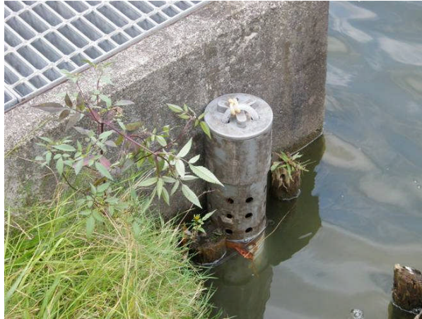
図 2-2 穴門堀の水位連続測定状況
