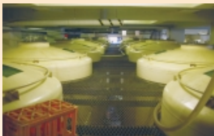
原酒の澱(おり)を沈殿させるタンク。それぞれ1升瓶200本分です
