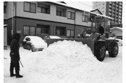
助手の誘導により安全に作業しました(写真は広面)
