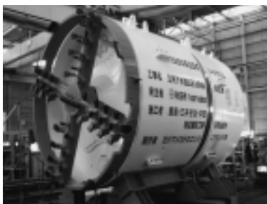
下水道管設置のためのモグラマシン
