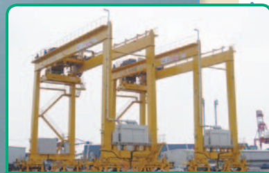
トランスファークレーン
