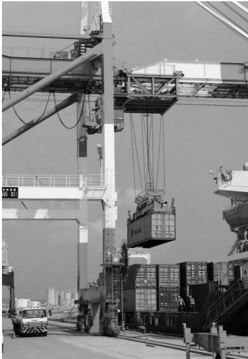
ガントリークレーンで効率よくコンテナの積みおろし
