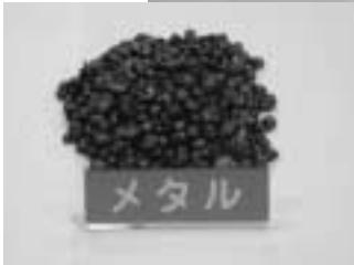
スラグは路盤材・ブロック等に、メタルは重量骨材として再利用します
